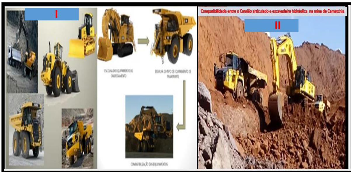
**Figura 12-** Equipamentos usados em minas a céu aberto. I-Equipamentos de carga e transporte a selecionar, II- Compatibilização entre o caminhão articulado e a escavadeira hidráulica na mina de Camatchia. Fonte: Autor
