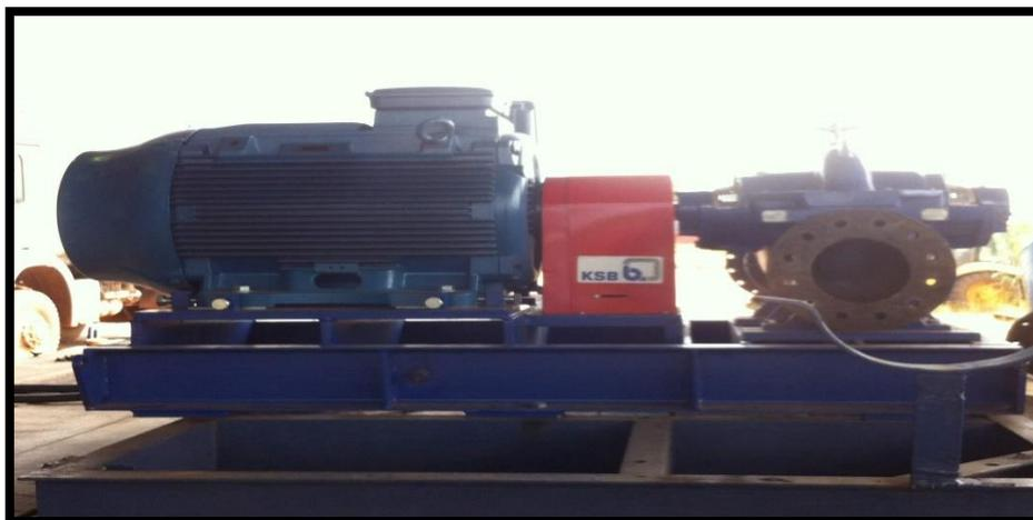
**Figura 30-** Preparação da nova Bomba KSB na zona de industrial. Fonte: Autor
