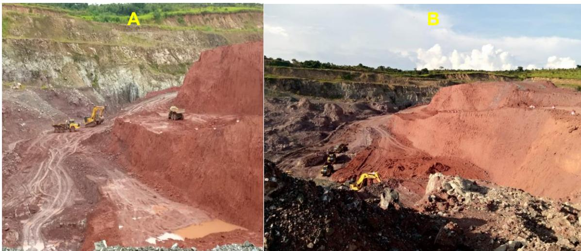
**Figura 21-** Taludes na zona de exploração de TKB e TSB. A-Adjacente a zona dos solos residuais e gnaisses alterados, B- Na zona com gnaisses resistentes. Fonte: Autor
