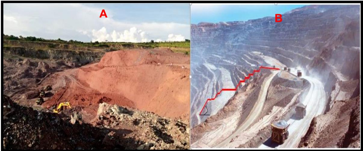
**Figura 10** – Lavra por bancadas, em minas a céu aberto. A-Cava com imprecisa geometria nas bancadas, B-Cava com boa geometria nas bancadas. Fonte: Adaptado de Gemcom Whittlem, Surpac, 2007.
